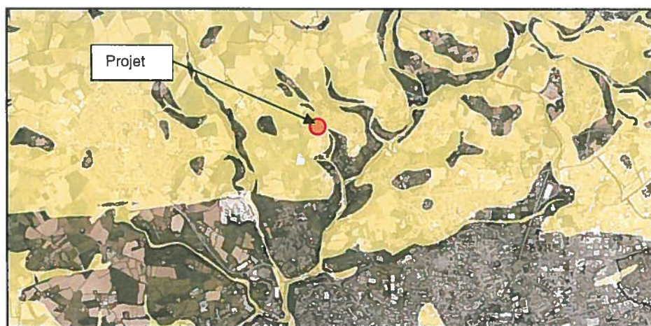
Figure n°8 : extrait de la carte d'aléa retrait-gonflement des argiles sur la commune de Bohars
