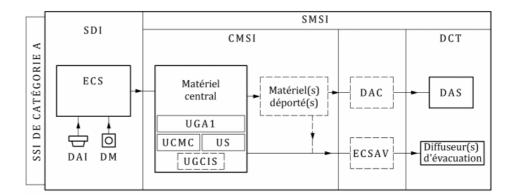
Nota: Les traits reliant les différents blocs indiquent uniquement les liaisons fonctionnelles. Les blocs figurant en pointillé correspondent à des fonctionnalités rendues éventuellement nécessaires en fonction des choix technologiques adoptés
