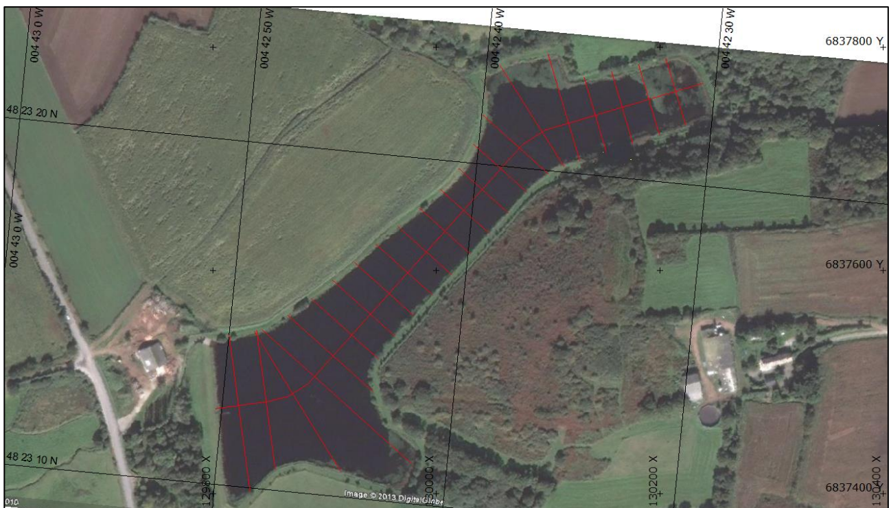
Figure 3 : Image satellite de la retenue d'eau avec le plan de profilage en rouge (In Vivo, 2013)
