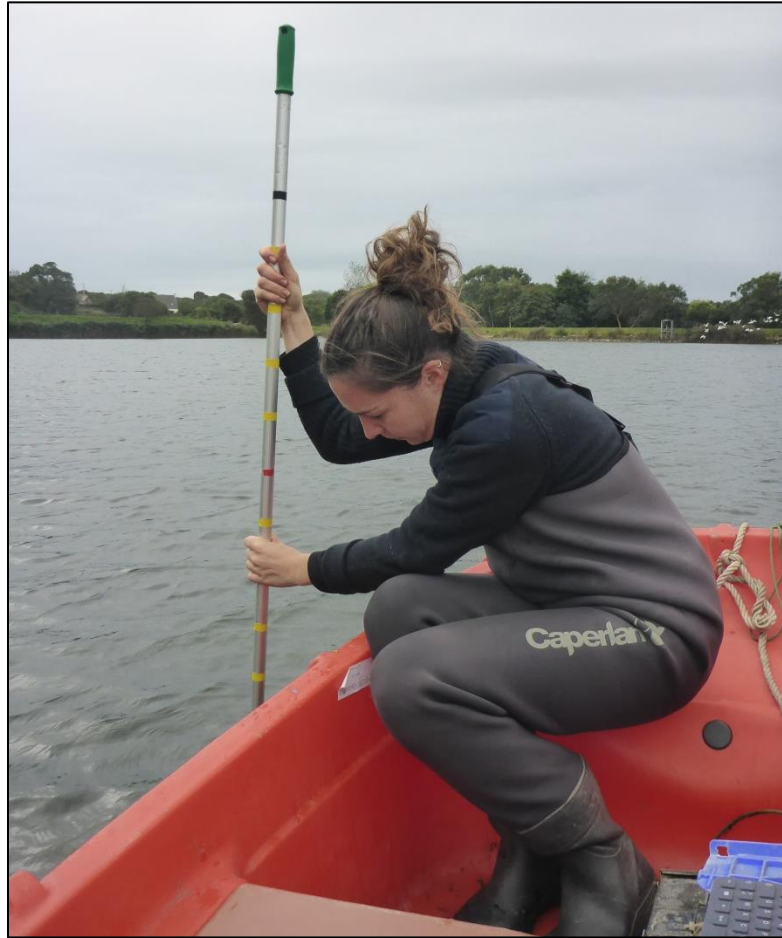
Figure 11 : Estimation de l'épaisseur de vase à la pige graduée (In Vivo, 2013)
