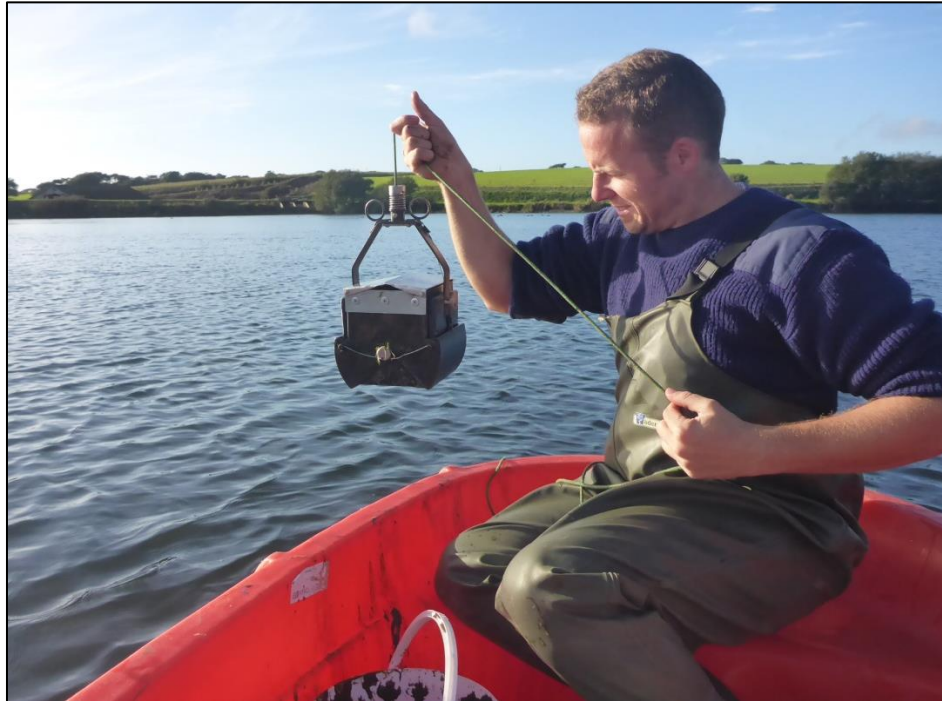
Figure 13 : Prélèvement de vase à la benne Eckman (In Vivo, 2013)
