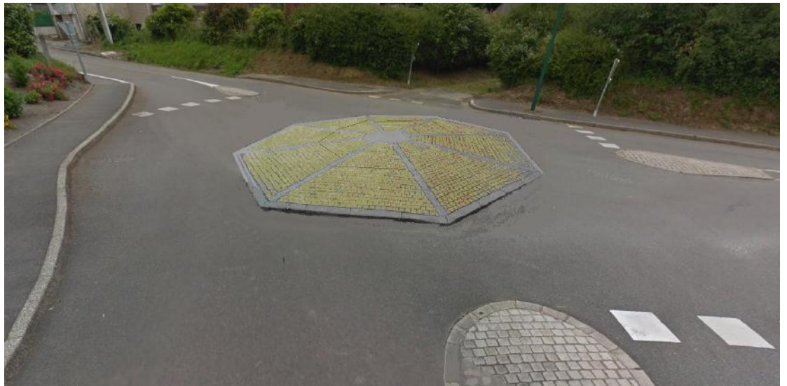
Exemple (îlot enrobé bombé recouvert de ROXEM)
