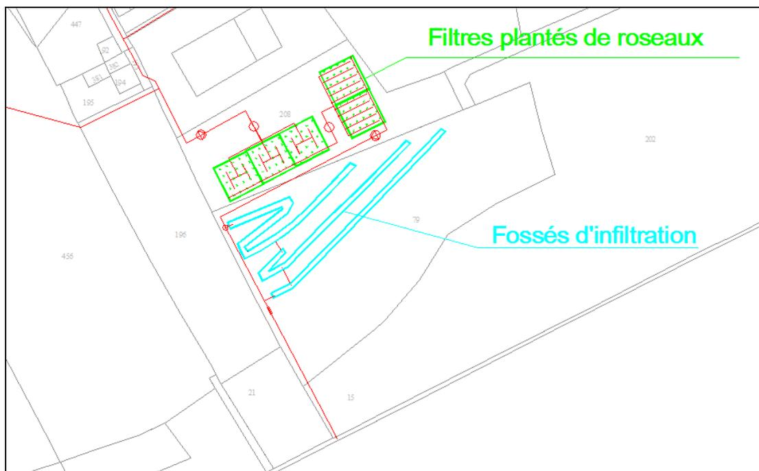
Figure : Schéma des ouvrages d'assainissement
