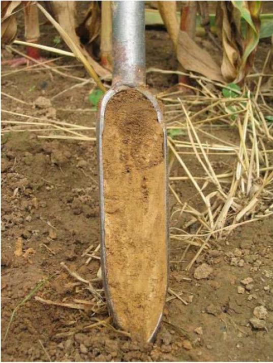
Retirer la terre qui se trouve à l'extérieur de la « carotte » en grattant les bords avec un couteau et supprimer les 2 cm ou plus de terre de la partie supérieure suivant la situation, ceci afin d'éviter toute contamination d'un horizon à l'autre (tarière hélicoïdale).
