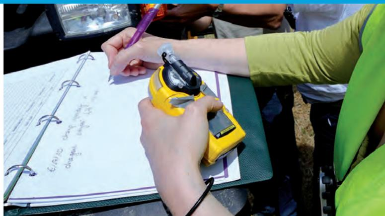
■ Les cellules des détecteurs doivent être maintenues et remplacées conformément aux instructions du fabricant.
